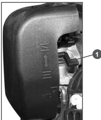
Рис. 9 Расположение воздушной заслонки
