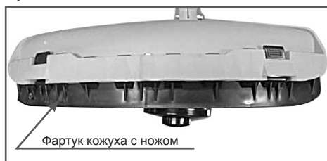
Рис. 7 Установка фартука защитного кожуха
