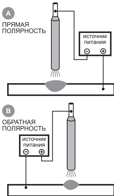
Рис. 3. Места установки сварочных кабелей
