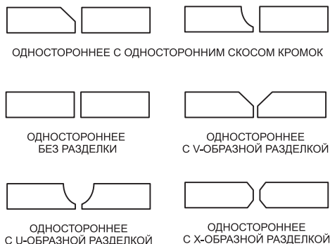
Рис. 6 Виды стыковых соединений
